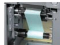
**ラベル台紙内部巻取り機構(剥離運用での使用時)**
